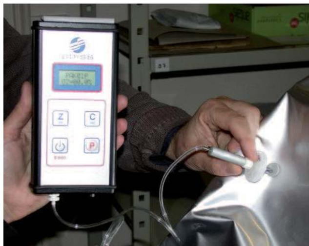
Mesure du taux d'oxygène d'une bulle de traitement de désinfestation par anoxie statique
