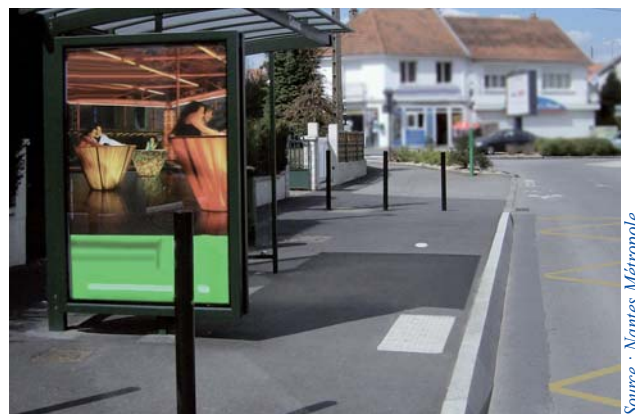
Point d'arrêt à Nantes avec bande DPSU.
