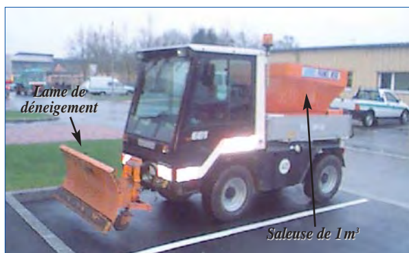
Laveuse équipée pour la viabilité hivernale
