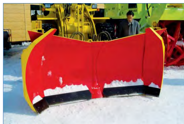
Etrave ou lame transformable
