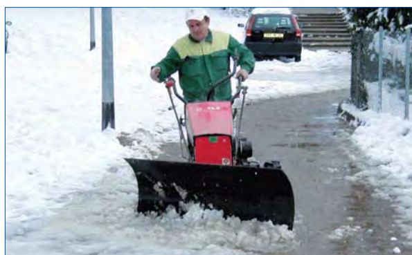
Motoculteur avec lame
