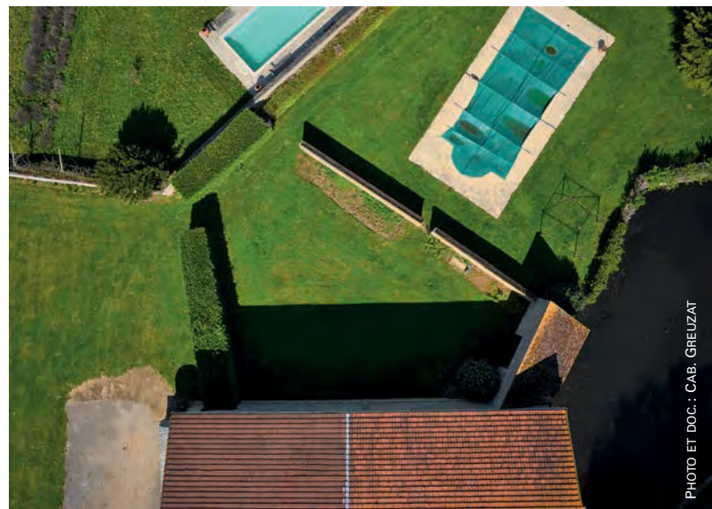
Artefact provoqué par le passage d'un nuage (zone noire). A droite, les ombres portées empêchent le logiciel de lire les données.
