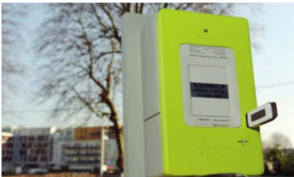
Le compteur intelligent Linky, qui suscite autant de controverses (cf page 10), permet de remonter les données de consommation via les réseaux radio, évitant ainsi de mobiliser des agents pour les relevés manuels.
