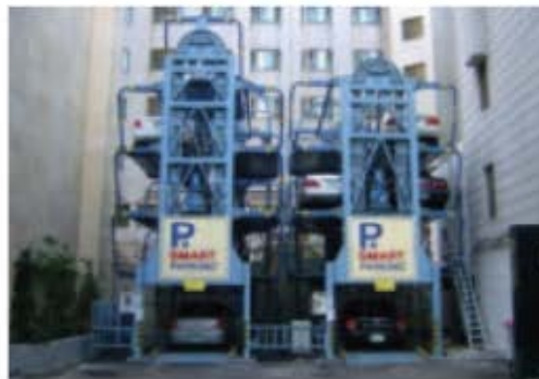
Une approche « smart » pour gagner de l'espace : garer les voitures dans des carroussels qui les stockent en hauteur.
