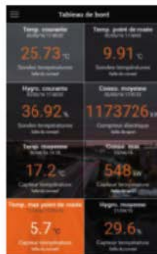
Une appli sur smartphone permet aux gestionnaires de la ville de suivre les consommations de la commune, de suivre les différents capteurs et de recevoir des alertes.
