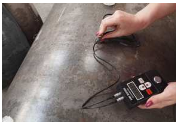
Inspecteur de l'ASN contrôlant un cylindre 30B en fabrication dans un atelier en Roumanie
