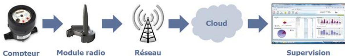
Réseau d'eau intelligent captif fondé sur des compteurs communicants
