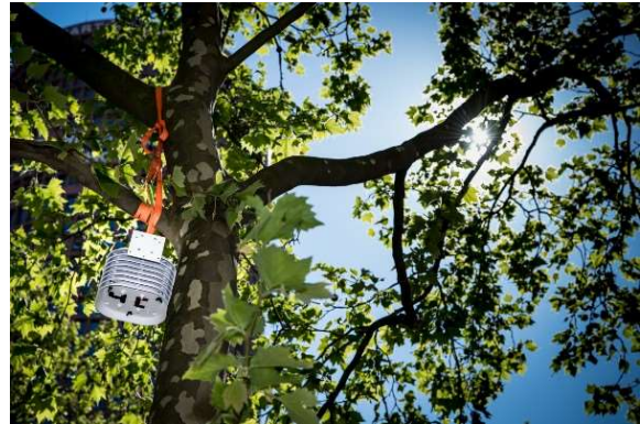
Des capteurs de température ont été installés dans les arbres de la rue Garibaldi à Lyon.
