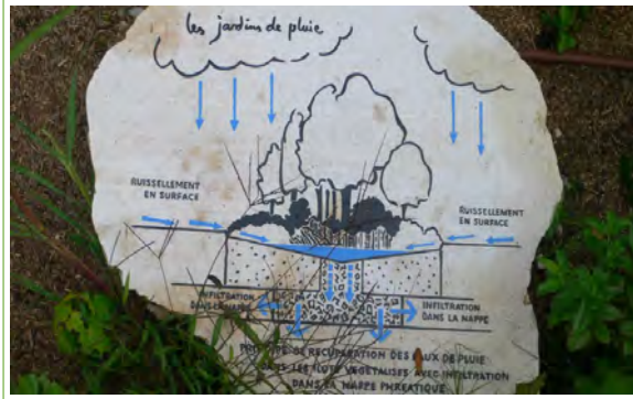
Support pédagogique présentant le fonctionnement des jardins de pluie présent sur le site (source : Saint Martin d'Hères)
