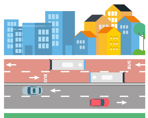
Figure 6 : Couloir bus latéral bidirectionnel à contre sens de la circulation générale
