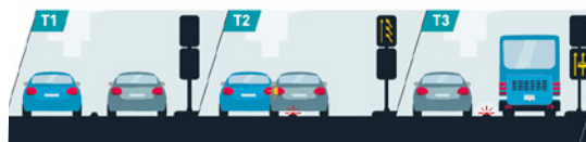
Couloir bus temporel à Lyon
