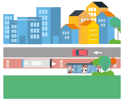
Figure 3 : Couloir bus latéral à contre-sens de la circulation générale
