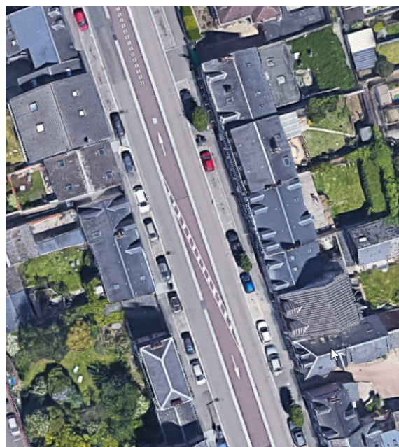
Couloir axial alterné route de Dieppe à Rouen (source : ©2022 Google)
