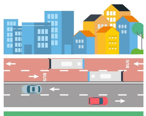
Figure 6 : Couloir bus latéral bidirectionnel à contre sens de la circulation générale
