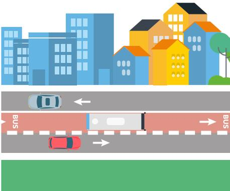
Figure 4 : Couloir bus axial unidirectionnel
