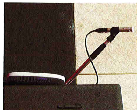
Posée dans un angle de la salle, la borne Shure MXCWAPT assure la réception de tous les signaux des postes, alors que le micro capte l'ambiance du lieu pour aérer le mixage son.
