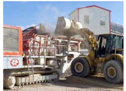
Les déblais de tranchées sont habituellement évacués en décharge (notamment le béton bitumineux). Le projet vise à recycler un maximum de matériaux, réduisant de fait l'apport de matériaux neufs, et contribue à la réduction de la circulation d'engins et de l'empreinte CO<sub>2</sub>.
