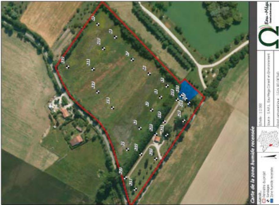
En conséquence, l'angle nord-ouest du site projeté pour les bassins d'infiltration est bien celui qui présentera d'une part l'épaisseur non saturée la plus importante avec une hydromorphie à plus de 1m/TN, d'autre part le moins de risque de remontée de nappe jusqu'au fond des bassins.
