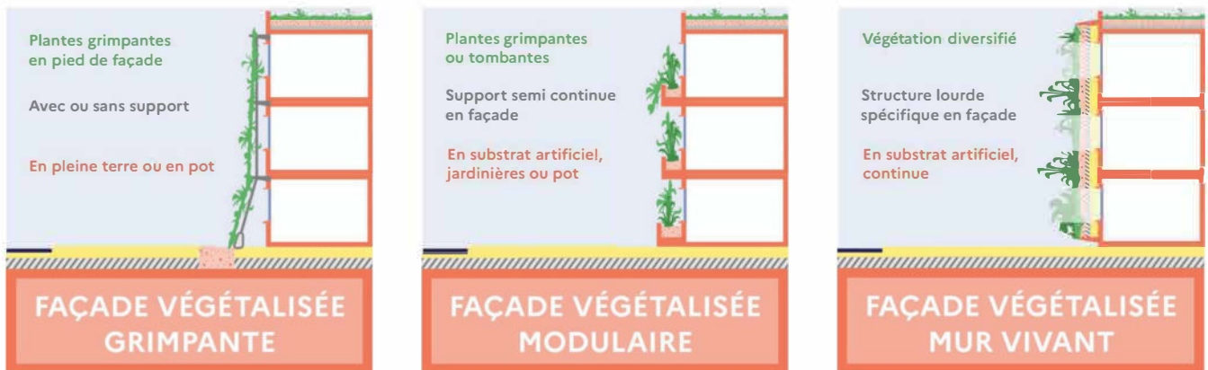
Figure 7 : Illustration des techniques de façade végétalisée
