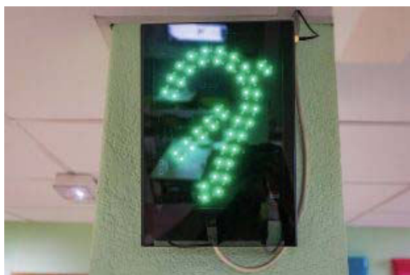
La mesure du bruit s'affiche sur un tableau lumineux connecté représentant une oreille qui passe du vert au rouge selon les niveaux captés. D.R
