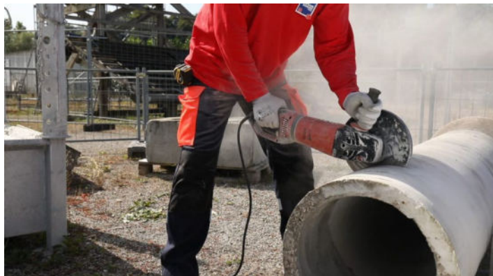
Utiliser un disque approprié à la découpe du béton et en bon état réduit la durée de la découpe et donc l'exposition au bruit.
