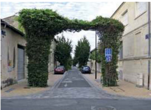
Cette entrée de zone de rencontre est matérialisée par un effet de porte. L'entrée est visible de loin, repérable et identifiable. Le masque à la visibilité que constitue la porte est compensé par la faible vitesse des véhicules et la priorité absolue du piéton.
