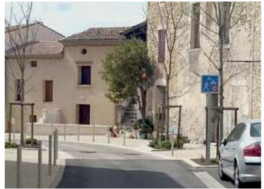
Dans cet exemple, l'entrée de la zone de rencontre en section courante est matérialisée par un changement de matériau et de coloration de la chaussée. La couleur choisie se rapproche de celle utilisée pour les cheminements piétons.
