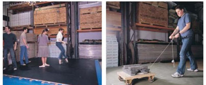
Les photos montrent les essais DIN 18032-2 en cours sur le sol WoodSpring à tissage panier de Harlequin avec surface Harlequin Cascade et des danseurs du Royal Ballet de Londres approuvant le sol d'essai.
