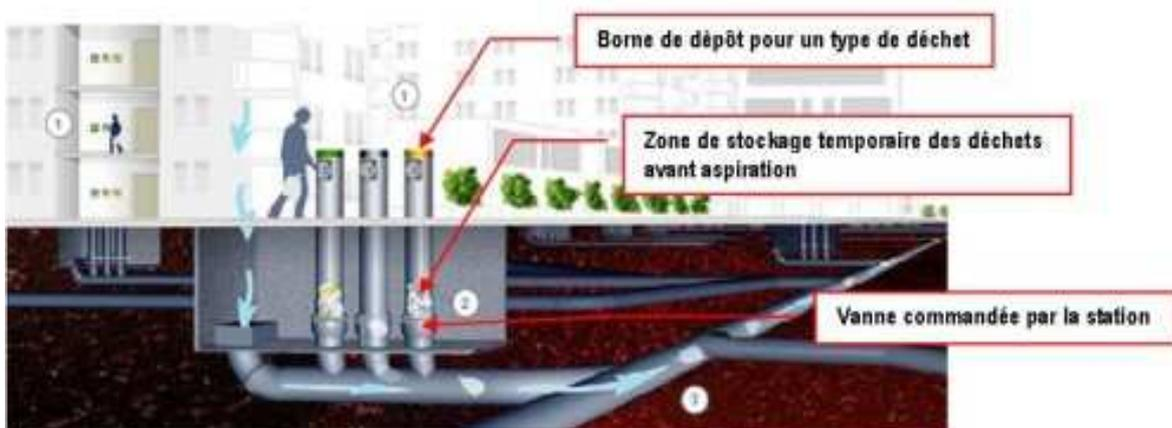
Le système est sans doute à la fois le plus efficace et le plus propre, puisqu'il remplace les trajets en camion par des pneumatiques à faible consommation électrique. Il est, malheureusement, essentiellement applicable dans les nouveaux quartiers, le creusement de conduits souterrains n'étant pas réalisable dans tous les environnements urbains ! Mais il gagnerait à être mis en place partout où cela est possible.
