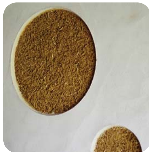
© Chanvriers en Circuits Courts - Enduit chanvre
