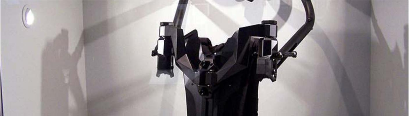
Les exosquelettes de travail sont des structures articulées externes d'assistance à l'effort, portées par l'opérateur, mécaniques, électromécaniques ou mécatroniques, destinées à renforcer les capacités physiques des travailleurs et leur productivité, tout en cherchant à lutter contre les troubles musculo-squelettiques (TMS)...
