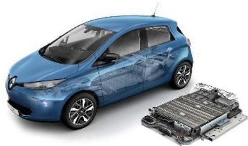
CL : A l'inverse des véhicules électriques Renault – équipés d'un « *Battery Management System* » empêchant toute combustion spontanée et d'un « *Fireman Access* » utile en cas de feu déclaré – l'extinction d'un autre modèle peut nécessiter de longues heures d'intervention et entraîner la fermeture de la voie de circulation...
