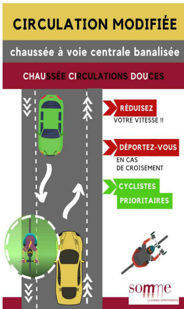
*Schéma explicatif du fonctionnement d'un chaudiou*
