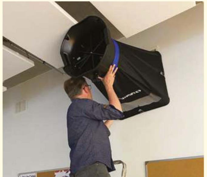
Mesure de débit avec un balomètre.
