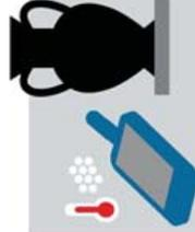
Un thermohygromètre numérique relèvera les niveaux de température et d'humidité relative dans les salles des collections.
