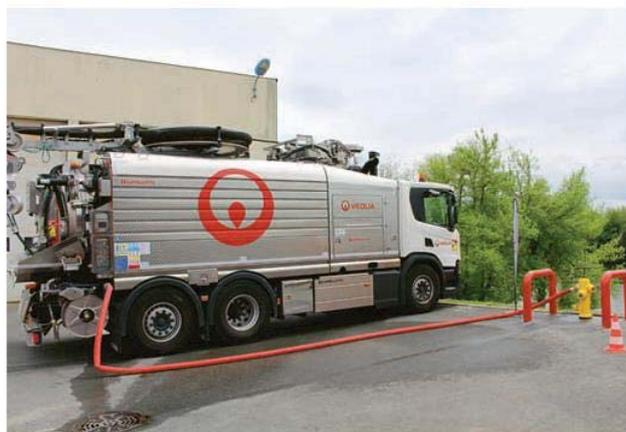
Avant le nettoyage de la voirie, les balayeuses font le plein, à la station d'épuration, des eaux usées préalablement filtrées, désinfectées et chlorées.
