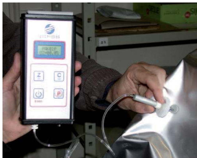
Mesure du taux d'oxygène d'une bulle de traitement de désinfestation par anoxie statique © Frédérique Vincent
