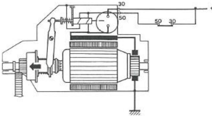
1 - Le conducteur actionne la clé de contact et l'interrupteur 30-50 se ferme
