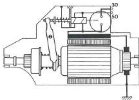
6 - Le conducteur relâche la clé de contact et l'interrupteur 30-50 s'ouvre.
