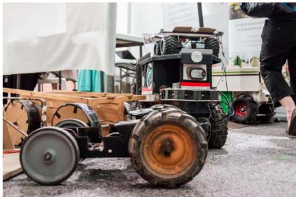
Du proto (1<sup>er</sup> plan) au robot final (au fond), les étapes de développement d'OZ, robot désherbant.
