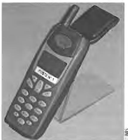
*Nouveau système DATI équipé d'une localisation GPS (l'antenne GPS est déployée sur le haut de l'équipement)*
