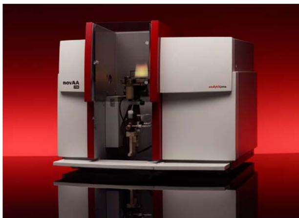
*Un spectromètre d'absorption atomique.*
