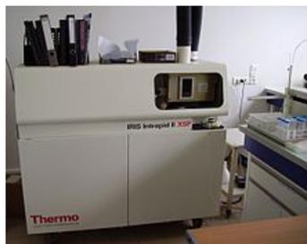
Un spectromètre ICP-AES
