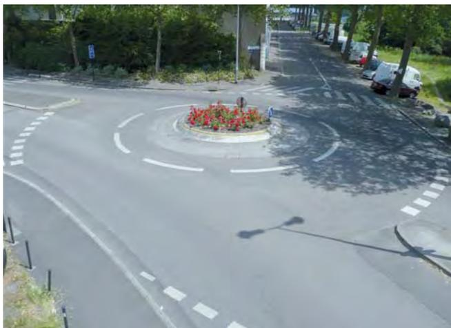
Sous ce nom se classe le carrefour giratoire commun en ville, de petite dimension, avec des entrées et sortie à une voie. Il doit permettre la giration de véhicules lourds, ce qui justifie un rayon extérieur supérieur à 12 m, mais 15 m peut être approprié, en particulier sur des lignes de bus.
